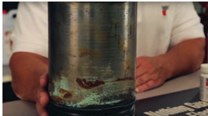
Последствия использования охлаждающей жидкости сомнительного происхождения и устаревших или упрощенных формул
